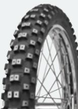
Profildesign für Vorderreifen. Empfohlen für mittleres bis hartes Gelände.
