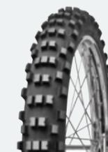
Profildesign für Vorderreifen. Empfohlen für weiches bis mittelhartes Gelände.
