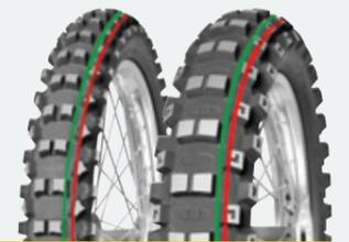
Motocross-Reifen für mittleres bis hartes Gelände. Form und Lage der Stollen sorgen für maximale Traktion und Kontrolle. Die Stollen am Vorderreifen garantieren Geradeauslaufstabilität, während die hinteren Pendants guten Kontakt zum Untergrund gewährleisten. Der TERRA FORCE-MX MH zeigt eine weichere Lauffläche als der TERRA FORCE-MX SM.
