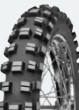
Profildesign für Hinterreifen. Empfohlen für weiches bis mittleres Gelände.
